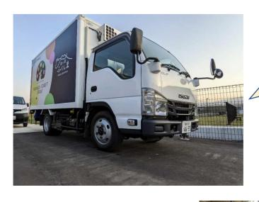
荷室が2つに分かれ、それぞれに冷凍機を搭載した特殊仕様のトラック。 保存温度帯の違う荷物を同時に輸送する事が可能。 最大積載量は2000kgと、輸送力も十分。
