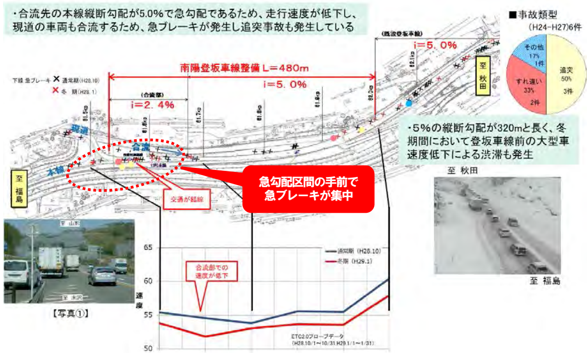
▲ETC2.0を用いた交通安全対策の例 (国道13号南陽登坂車線整備)
