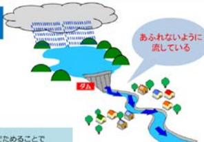
流れ込んだ水をダムでためることで川にいきなりに流さず、洪水が起きないようにします。
