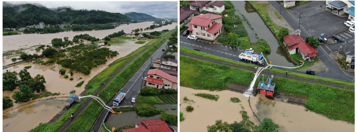
令和4年8月出水 長井市木蓮川水門 排水ポンプ車 60m 3 /min×1台
