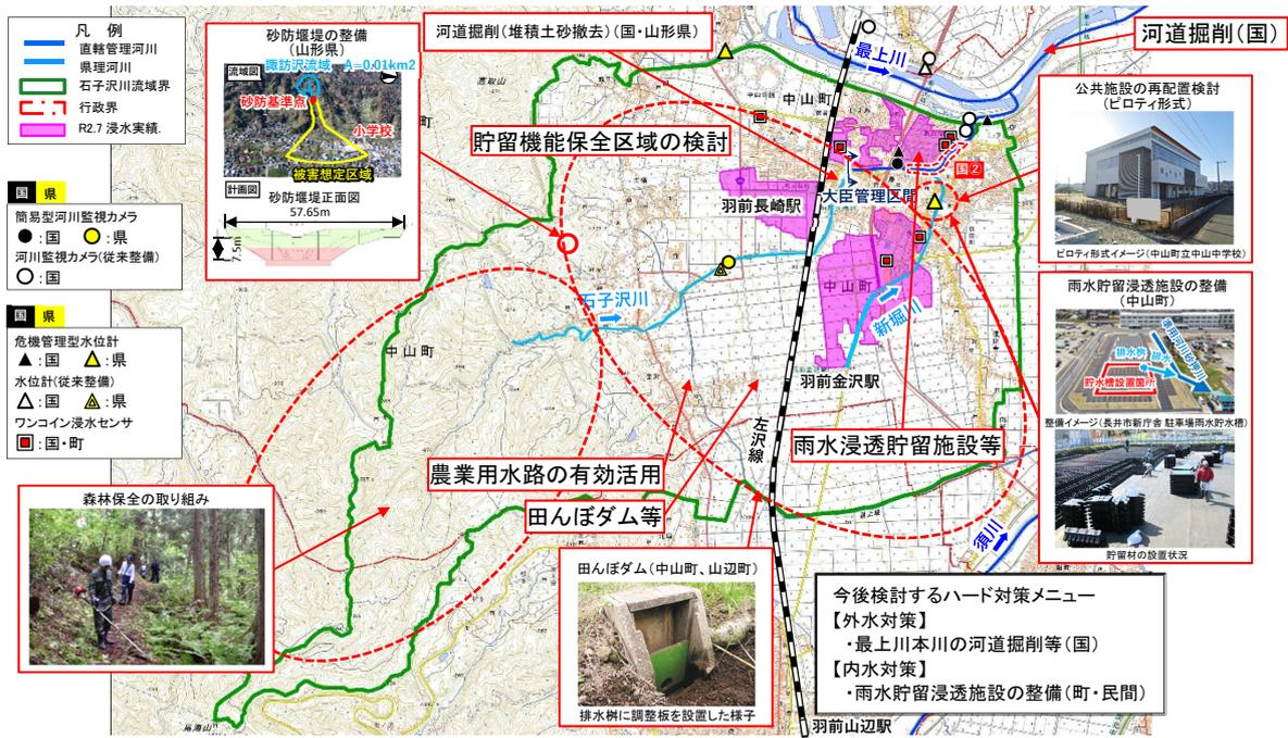
図 2.1.3 流域水害対策として想定される取り組み事例その2
