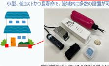
実証実験に用いている6種類の浸水センサ
