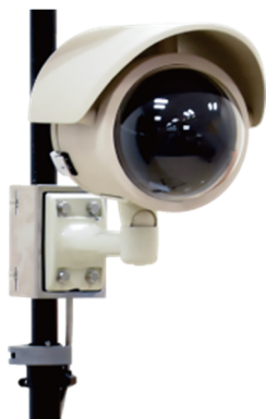
設置した簡易型河川監視カメラ
