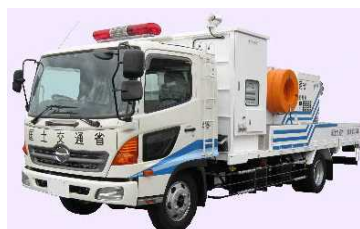
排水ポンプ車
