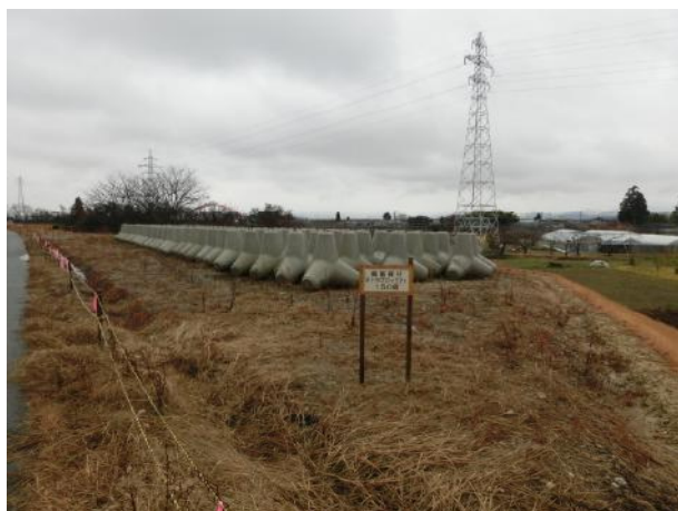
水防資機材の備蓄
