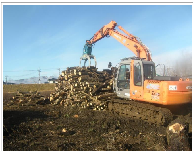
グラップル付BHによる集積作業(幹)
