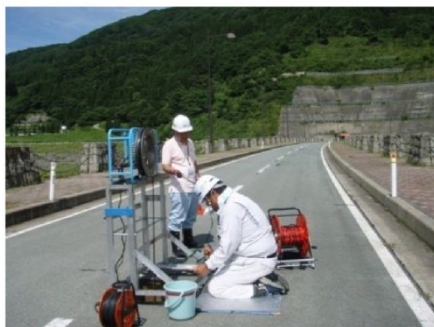
ダム天端の埋設機器観測状況
