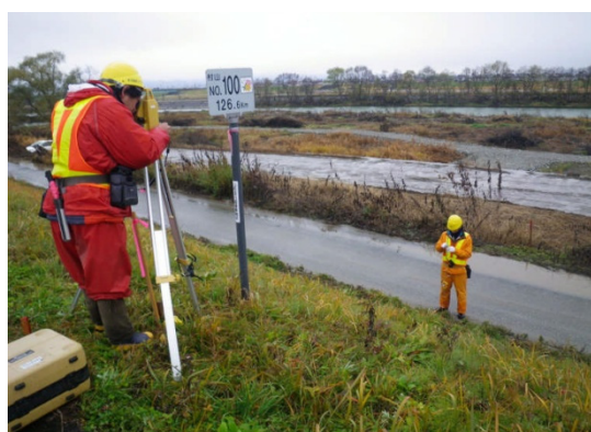
河川横断測量の様子
