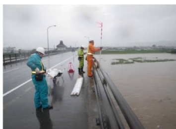
浮子による流量観測（洪水時）
