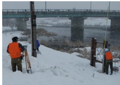
定期横断測量の状況
