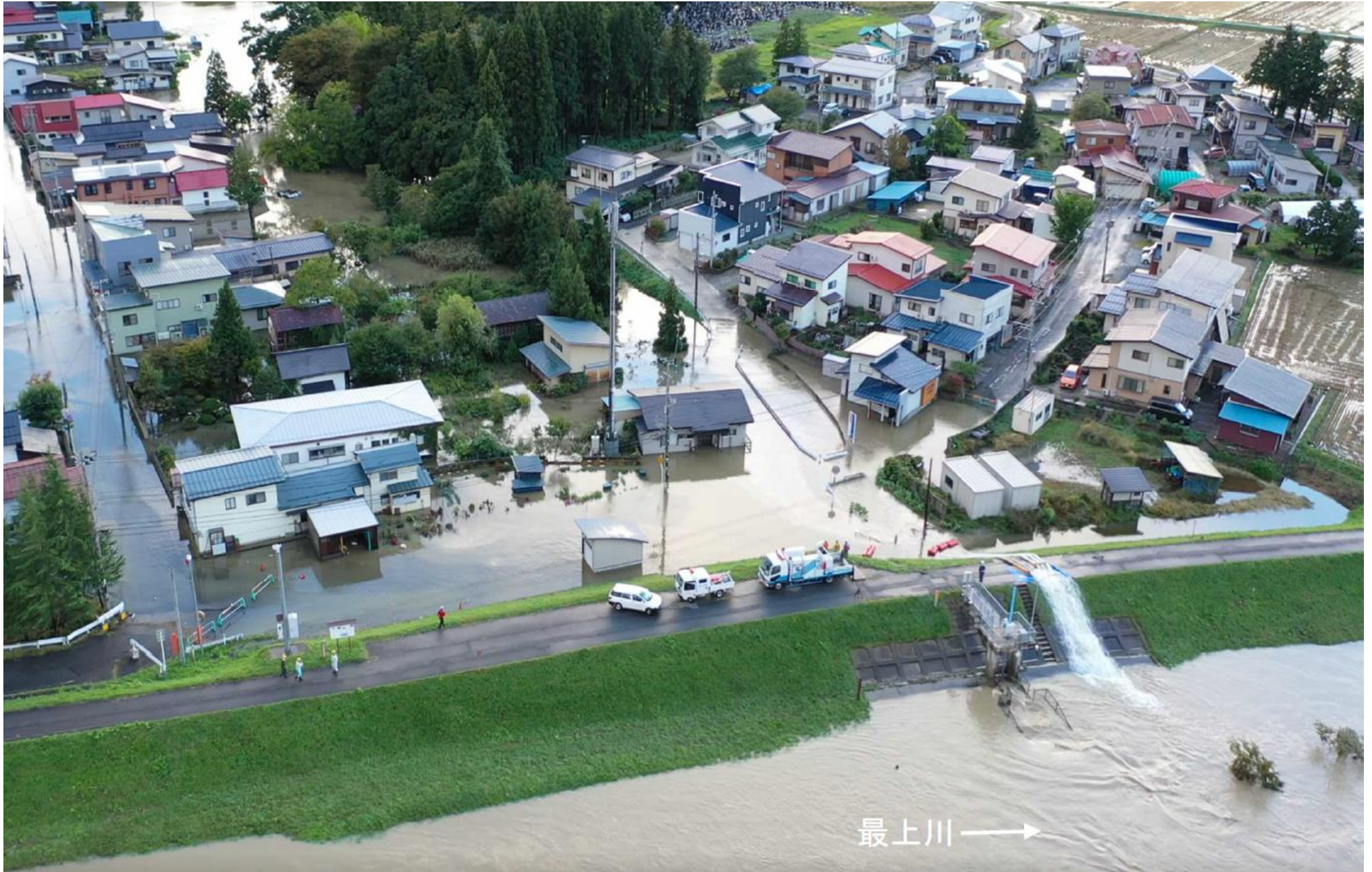
たか はた まち ぬか の め しんすい ひが 高畠町糠野目地区の浸水被害
