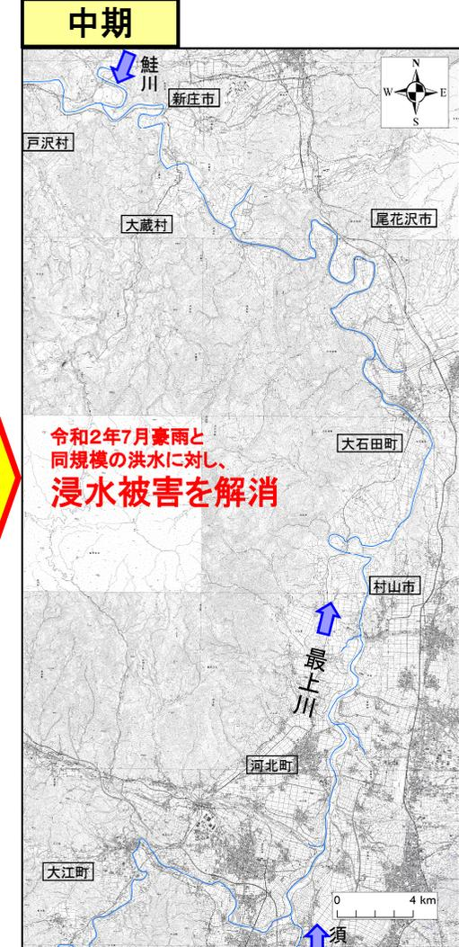
※直轄管理区間において、中上流区間でR2年7月豪雨と同規模の洪水が発生した場合に、氾濫ブロックで被害最大となる1箇所を堤防決壊させた場合の氾濫想定範囲
