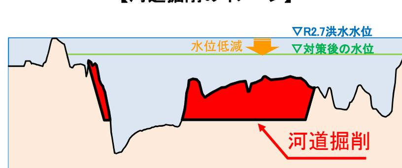
※堤防の法線・断面、河道掘削の等は、今後の詳細検討により決定します。
