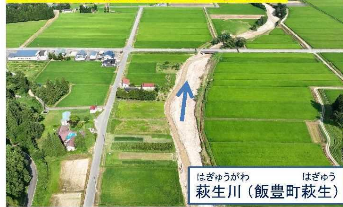
広範囲に渡る護岸損壊・土砂堆積・浸水
