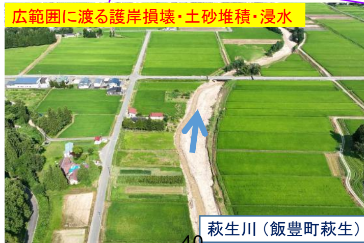
護岸損壊(120m)、市道橋流失
