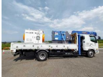
▲山形県の排水ポンプ車
