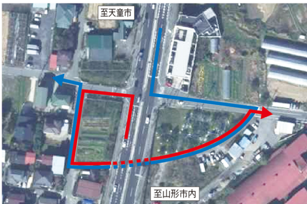
国道13号を走行する車両は、交差点が右折禁止のため大きく迂回する必要がある
