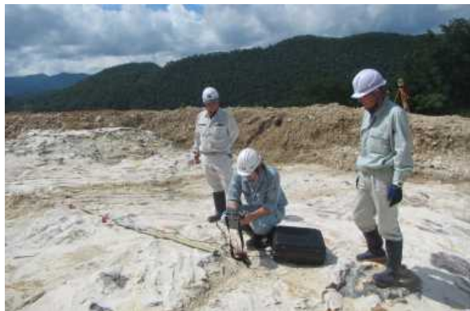
▲切土着手後の土質状況を踏まえた岩盤線確認状況(弾性波探査)
