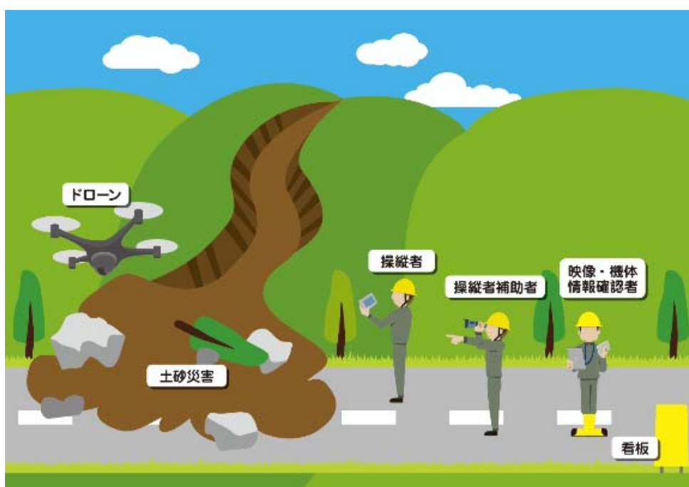
図1-5 ドローン撮影体制(土砂災害の例)
