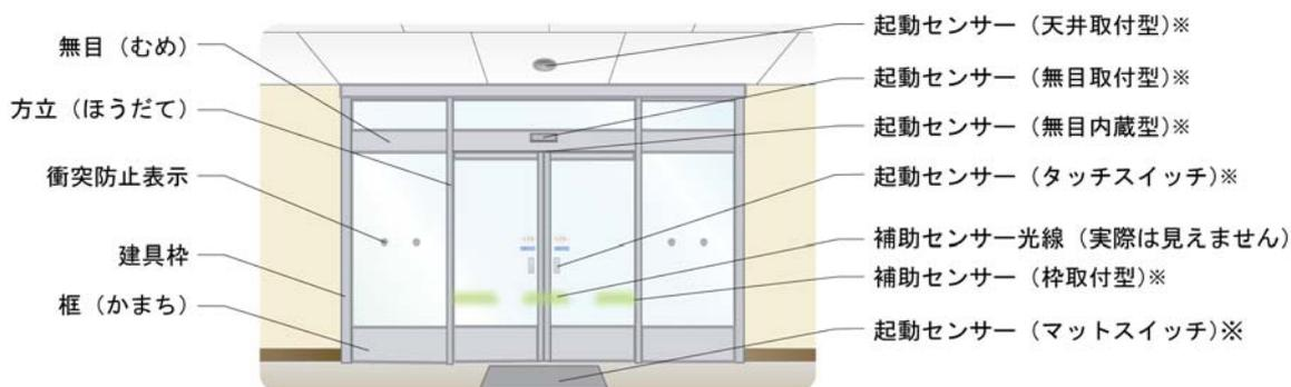
※図はセンサー等の名称を説明するためのものです。実際の自動ドアに上記すべてが併設されているわけではありません。センサーは図示のほかに、壁付きスイッチ、フットスイッチなどの各種形式があります。
